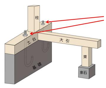
アンカーボルトの部分 だけで締結しているの で応力が集中すれば土 台が割れる等の不具合 が発生しやすいです。実 際のボルト間隔はもっ と広いです。 (ボルトが腐食していれ ば特に脆弱)
